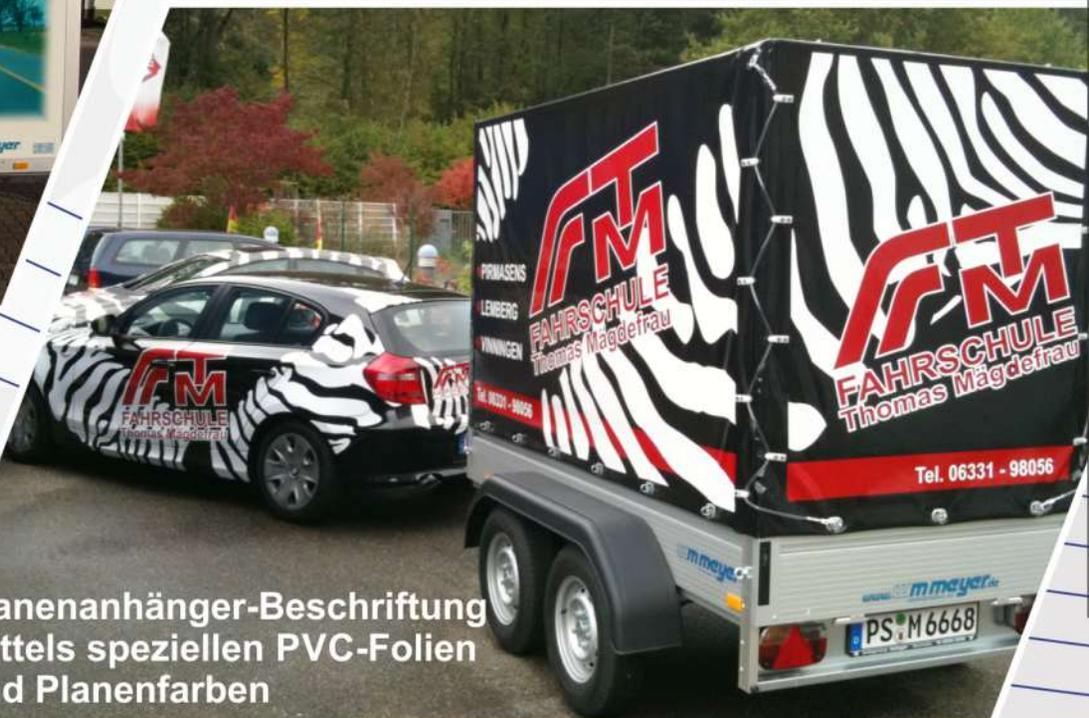
Planenanhänger-Beschriftung mittels speziellen PVC-Folien und Planenfarben
